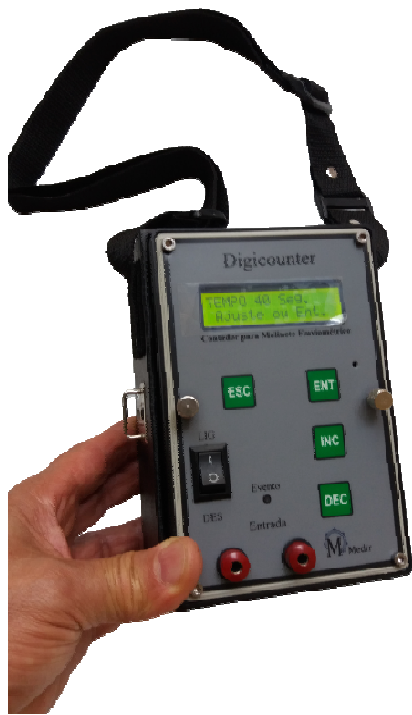
Digicounter Modelo HY -18. Contador universal de pulsos para Molinete e Micro Molinete Fluviométrico
